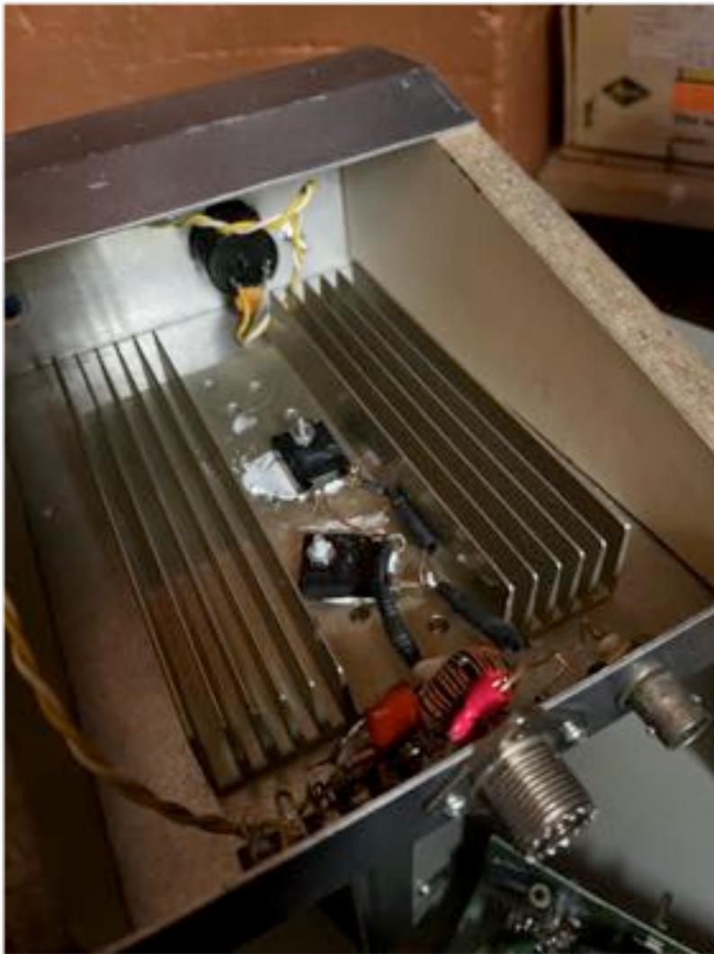
En construction! Les deux résistances de 100 Ohm sont connectées en parallèle sur le dissipateur thermique. Le signal RF est introduit en arrière par le connecteur BNC ou UHF. Le transformateur est monté directement autour du fil du connecteur UHF aux résistances. Le signal du circuit convertit le signal RF à une tension continue, connectée à l'ampèremètre avant par les fils jaune.
