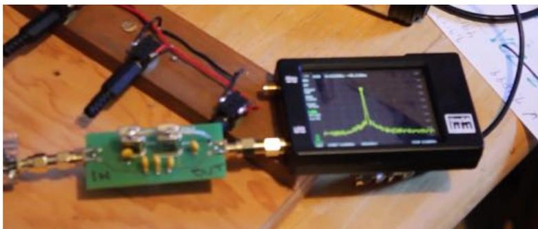
Fig. 3. La sortie du filtre de Cohn alimente l'analyseur de spectre qui montre la réponse souhaitée à 4,914 MHz.
