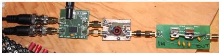
Fig. 2. La chaîne du mélangeur, du transformateur accordé et du filtre de Cohn
