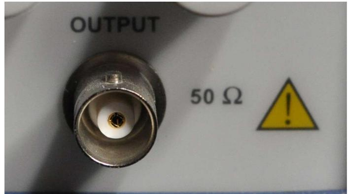
Figure 4: BNC femelle sur un boîtier
