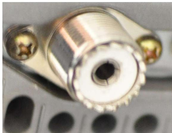
Figure 2: Connecteur UHF SO-259 sur un boîtier
